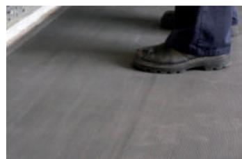
Tappeto leggero isolante per il lavoro sotto tensione elettrica. Progettato per l'uso di fronte a quadri elettrici e apparecchiature ad alta tensione, per la sicurezza degli operatori contro le scosse elettriche. La superficie è scanalata per evitare lo scivolamento.
