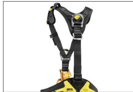
Le imbracature complete ASTRO BOD FAST sono dotate di un punto di attacco dorsale per collegare un sistema di arresto caduta. In caso di caduta su questo punto, una regolazione corta della lunghezza tra la cintura e i cosciali consente di ripartire il peso sui cosciali restando così sospesi più a lungo nell'imbracatura in attesa di soccorso.
