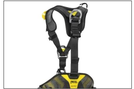
Le imbracature complete AVAO BOD e AVAO BOD FAST sono dotate di un punto di attacco dorsale per collegare un sistema di arresto caduta. In caso di caduta su questo punto, una regolazione corta della lunghezza tra la cintura e i cosciali consente di ripartire il peso sui cosciali restando così sospesi più a lungo nell'imbracatura in attesa di soccorso.
