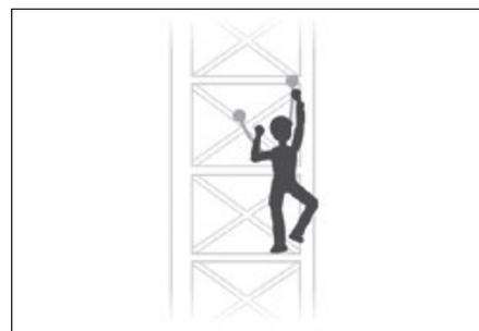
I cordini con due capi ABSORBICA-Y consentono di restare assicurati nel superamento di un frazionamento, scollegando e ricollegando in sequenza i due capi.
