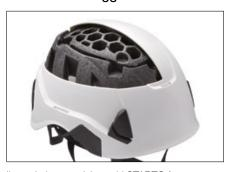
Il guscio interno dei caschi STARTO è progettato in due parti: EPP (polipropilene espanso) e EPS (polistirene espanso), per garantire maggiore leggerezza. L'assorbimento degli urti avviene per deformazione del guscio interno.
