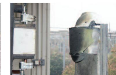
Certificazione GS-ET-29, classe 2, a 7 kA superata: la combinazione delle protezioni per testa e viso protegge l'utilizzatore
